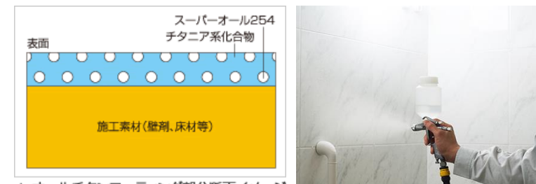
▲ オールチタンコーティング部分断面イメージ
